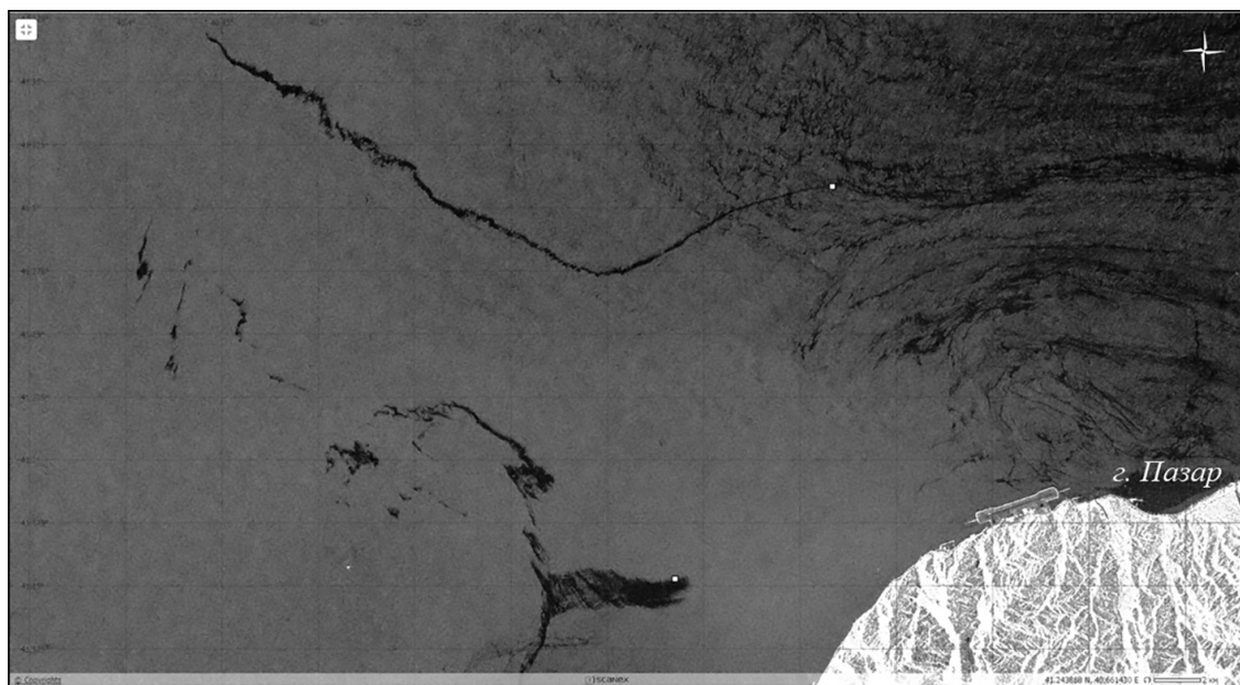
Рис. 7. Естественные нефтепроявления в турецких водах Черного моря напротив провинции Ризе на фрагменте радио-локационного изображения Sentinel-1A от 11.06.2022 (15:10 UTC). © ESA
